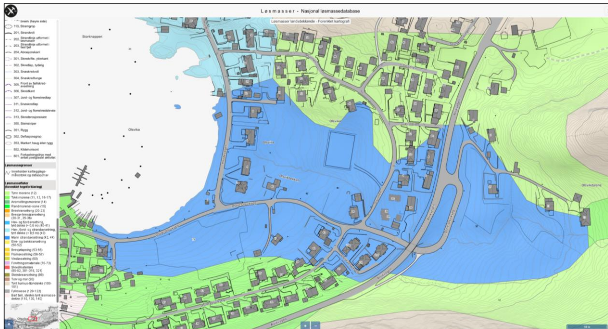
Vedlegg 2 Løsmassekart over planområdet. Marine strandavsetninger fremstilles med mørk blå farge på kartet. Kilde ngu.no, april 2023.
