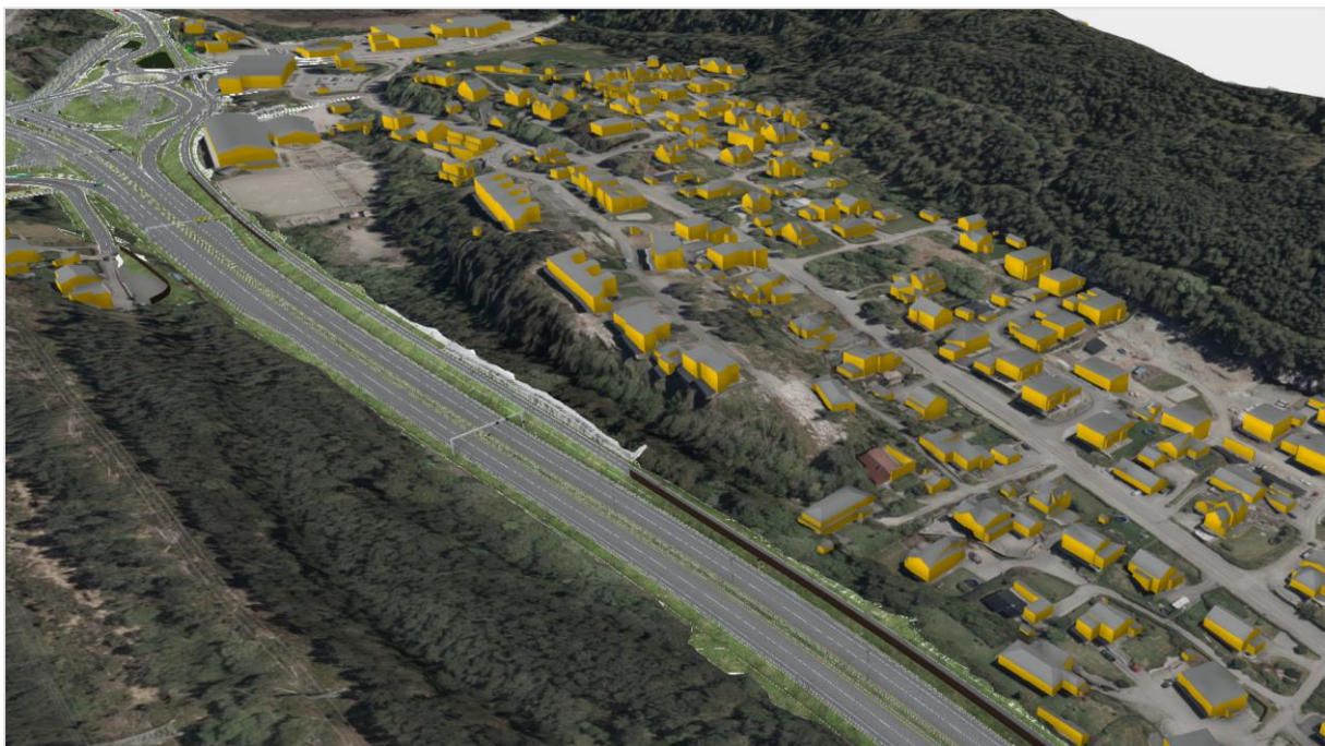
Figur 3: Utsnitt fra modell som viser 4-felts veg, støyskjerming og sykkelveg mot søraust
