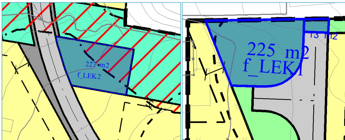
Figur 22 Oversikt regulert leikeareal, areal synt med stor skrift er teljande areal, liten skrift er tilleggsareal.
