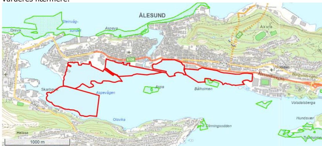
Figur 25. Utsnitt fra Kystinfo (Kystverket, 2022a) av Aspevågen med registrerte marine naturtyper (grønt omriss). Delområdene der det er anbefalt tiltak mot forurenset sjøbunn er markert med rødt omriss.
