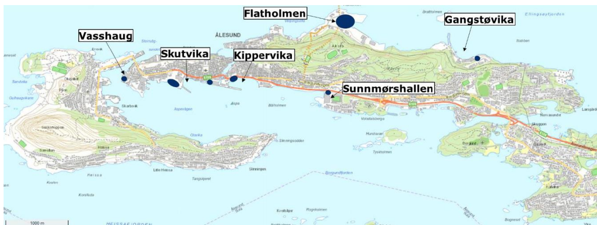
Figur 30. Kart over Ålesund sentrum og omegn med blå markeringer av parkeringsplasser, havneområder eller industriområder som potensielt kan være egnet for å etablere et anleggsområde i forbindelse med gjennomføring av tiltak mot forurenset sjøbunn i Aspevågen som del av Renere fjord Ålesund.
