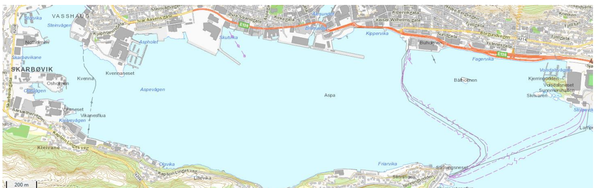
Figur 29. Kart hentet fra Kystinfo (Kystverket, 2022a) med markering av registrerte ledninger, kabler og rør (markert i grått eller lilla/fiolett) på sjøbunnen i Aspevågen.
