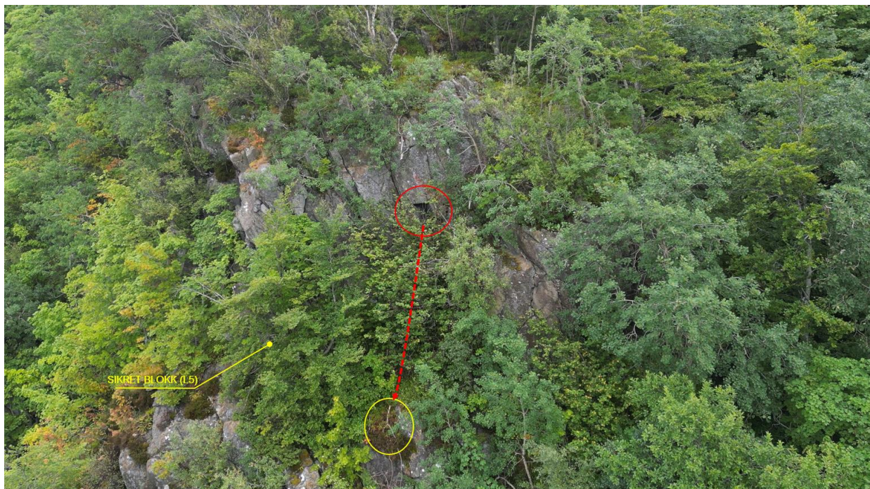
Figur 7: Rød sirkel indikerer mulig løsneområde for steinsprang. Gul ring viser skader på vegetasjon/skog som kan stamme fra steinspranghendelsen.
