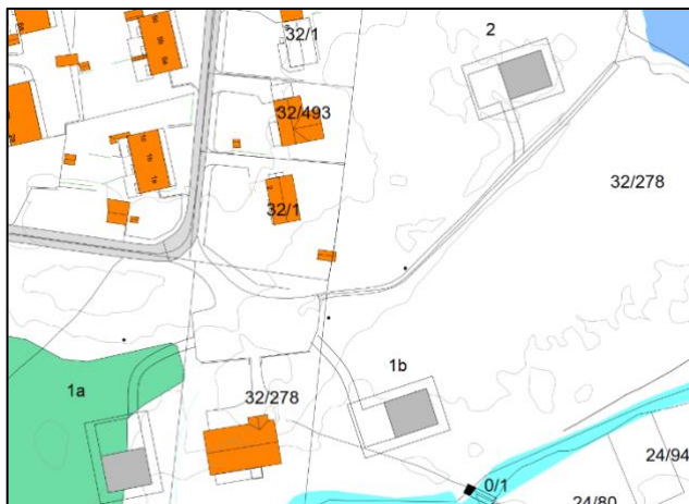
Figur 43: Plassering av pumpestasjonen med inngjerdet areal og atkomstveg. Tre alternativer er vist.
