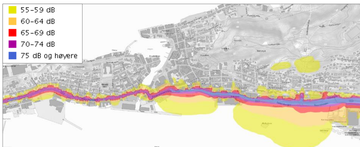
Figur 4-29 Støy fra vegtrafikk på E136 og fv. 390. Gul sone (mellom 55 og 65 dbA) og rød sone (65 dbA eller over) (Kilde: Statens vegvesen, kart hentet fra GisLINK)
