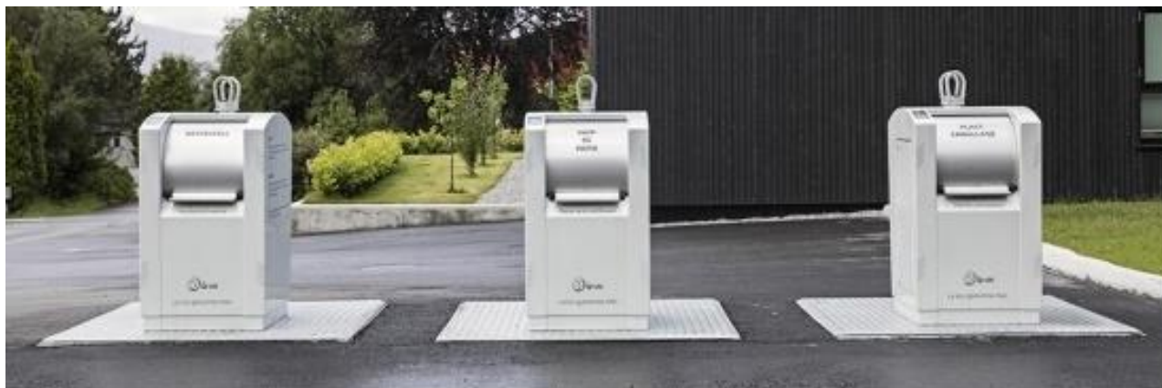
Figur 1: Hovedløsning for avfallshåndtering i planområdet er nedgravde avfallsbrønner. Illustrasjonen er hentet fra «Renovasjonsteknisk norm for Ålesundregionen». Bildet viser eksempel på nedgravde avfallsbrønner der bare innkastet er synlig. Disse leveres normalt i størrelse 3-5m 3 og tømmes av kranbil ved behov.
