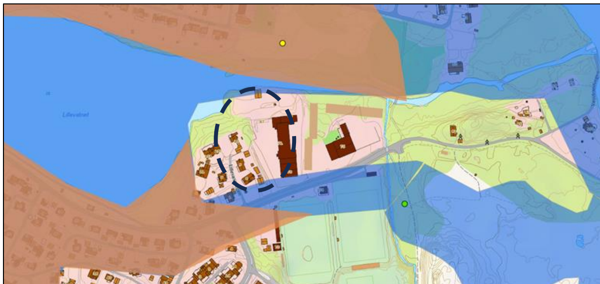
Figur 24 Kart fra oversiktskartlegging kvikkleire. Områder som har brun farge skal vurderes av geotekniker ved regulering. Områder med blå eller ingen farge behøver ingen vurdering av geotekniker ved regulering.
