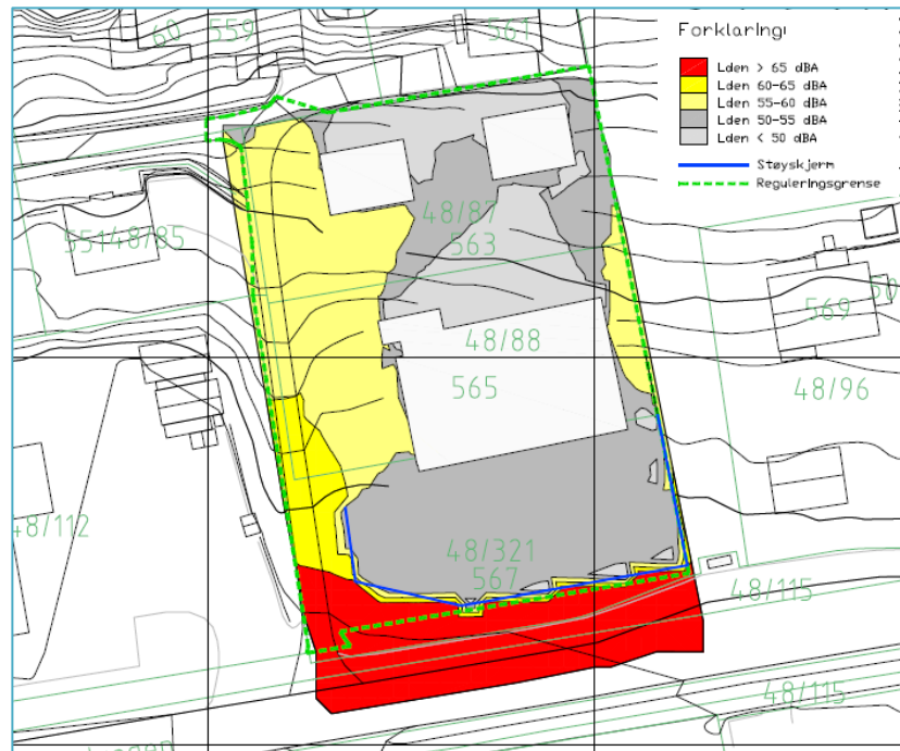
Figur 20 Støysonekart med støyskjermer og støy målt 1,5 m over terreng.
