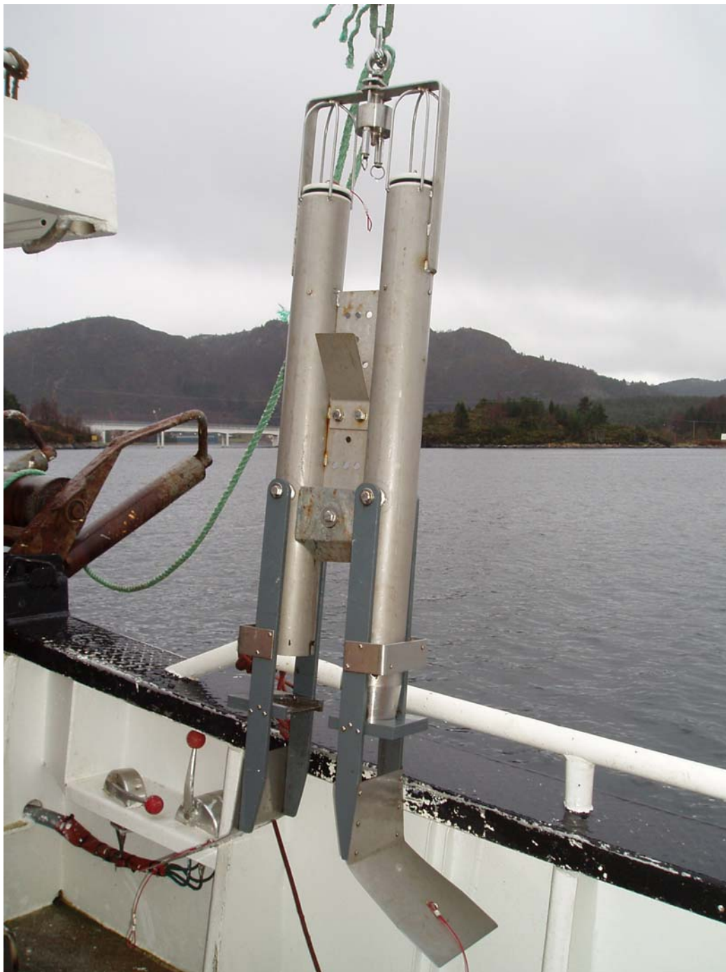
Figur 5. Geminicorer (merk at rørene av plast som skal tres inn i de to rustfrie rørene på bildet ikke er med). (Foto: John Arthur Berge)
