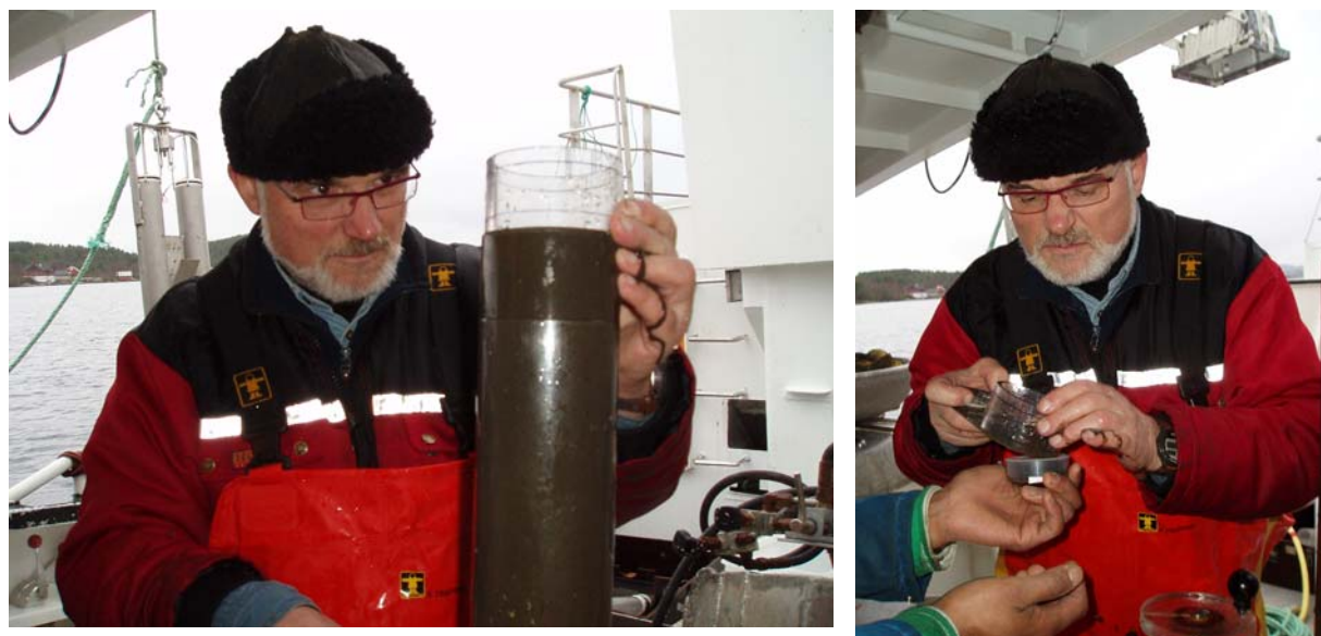
Figur 6. John Arthur Berge foretar snitting av en sedimentkjerne fra Geminicorer. (Foto: Nils-Roar Hareide)
