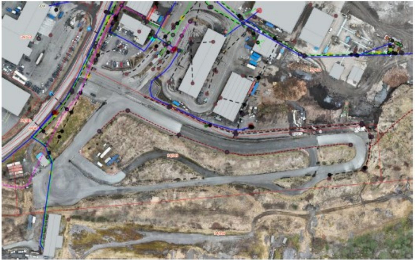
Dronefoto av området mars 2024 med kartlagde vass- og avløpsledningar
