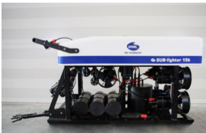
Figur 3. ROV benyttet i undersøkelsene i Aspevågen høsten 2021. Modellen er en SUB-fighter 15 K fra Sperre ROV technology.
